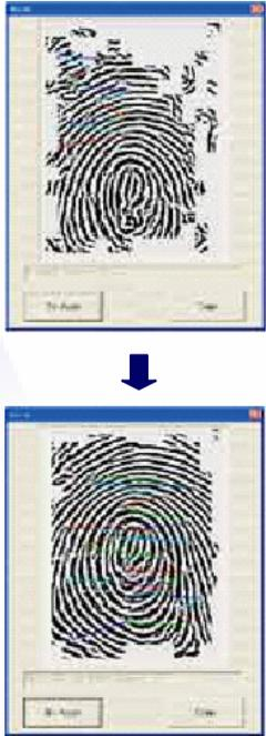
読み取った画像をなるべく補正し、認証に適切な状態で登録することで画像に多少の欠損があってもスムーズで確実な認証が行えます。何度も本人認証に失敗する（本人拒否）ストレスは、この技術の差に起因します。エムコマースは、独自の画像エンハンスメント技術により、7万分の4の本人拒否率を実現しています。
